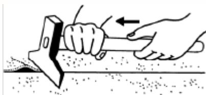
Le marteau à maroufler sert à fixer correctement les joints des moquettes, des sols PVC et du linoléum. Particulièrement conseillé pour les aiguilletés. Très équilibré et bien en main.
